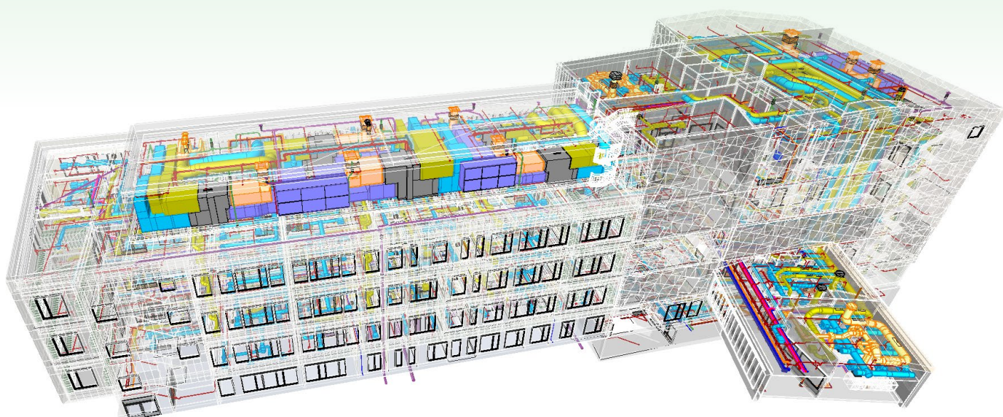
Bildet viser VVS-anlegget i BIM-modellen til Voldsløkka skole
