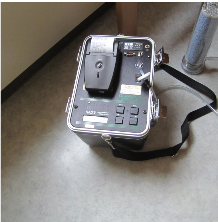
Radonmåling ved bruk av RAD7 | Foto: Multiconsult
